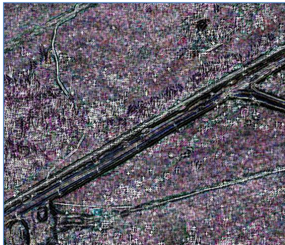
Снимок после обработки классическим методом призм с размером окна 4 \times 4
