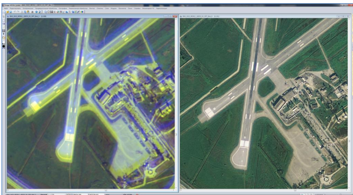
Рисунок 458 – Слева – цветосинтезированное изображение без совмещения каналов, справа – цветосинтезированное изображение со сведением каналов
